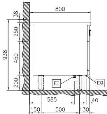
EI = Conexión eléctrica (energía)
